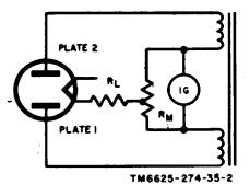
Figure 4. Rectifier diagram.
